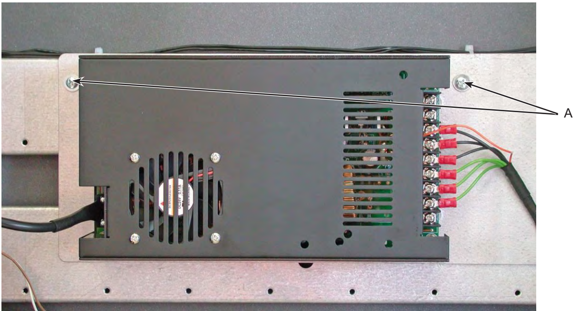
Ilustración. 5-4 Cambio de la fuente de alimentación conmutada
